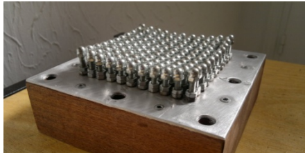
Fig. 4 Multipoint die set up for (MPFH)
